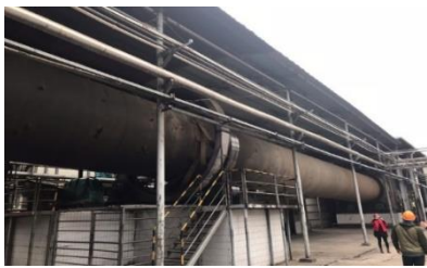
年产6000吨磷酸法活性炭多段加热炉
