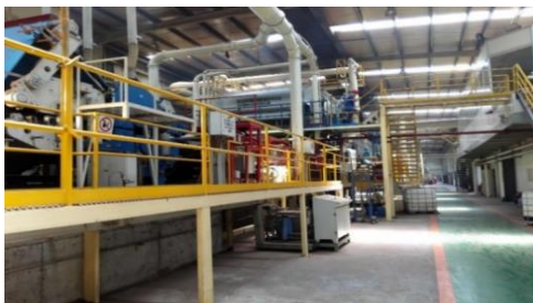
年产50万 \text{m}^3 的无醛刨花板连续平压生产线
