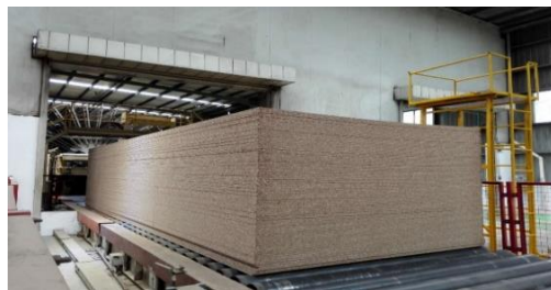
年产50万 \text{m}^3 的无醛刨花板连续平压生产线
