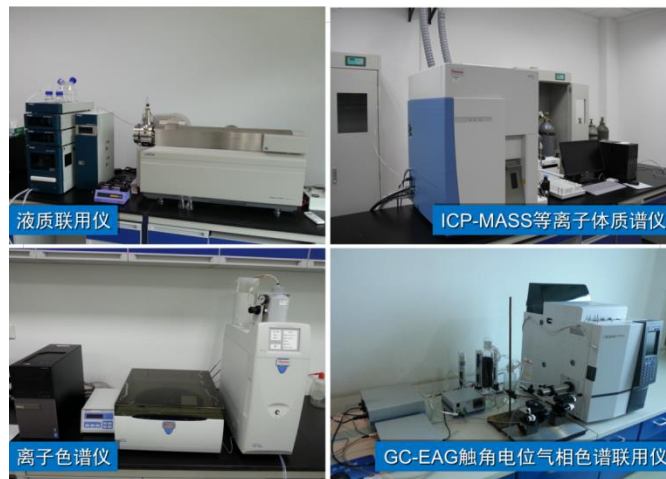
重点实验室部分仪器设备
